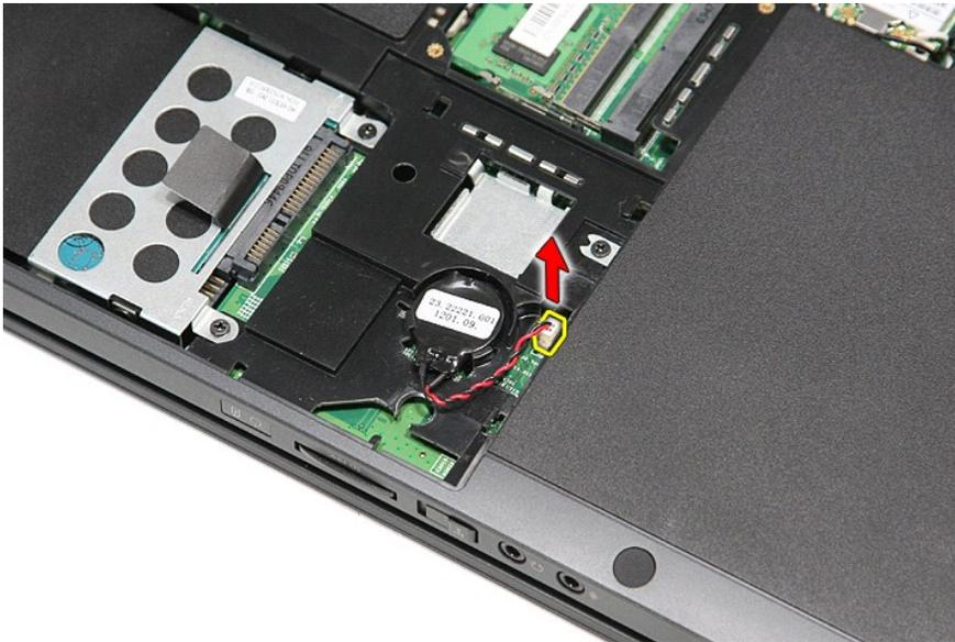
5. 코인 셀 배터리를 시스템 보드에 고정시키는 램을 살짝 들어 올려 코인 셀 배터리로부터 분리합니다.
